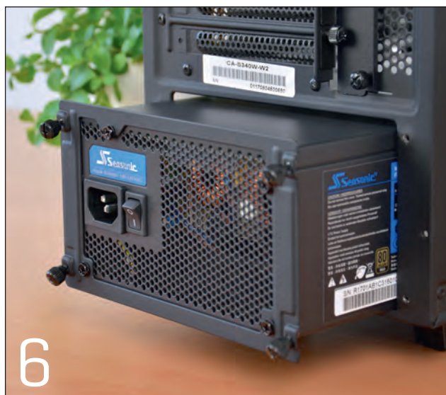
6 Plaats de voeding met de ventilator naar beneden. Je zult een 8-pins CPU- en 24-pins ATX-stekker naar het moederbord moeten leiden volgens de instructies van voeding en moederbord
