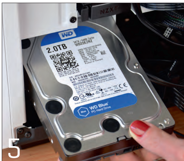
5 Plaats de harde schijf vóór je de voeding plaatst, dat monteert eenvoudiger
