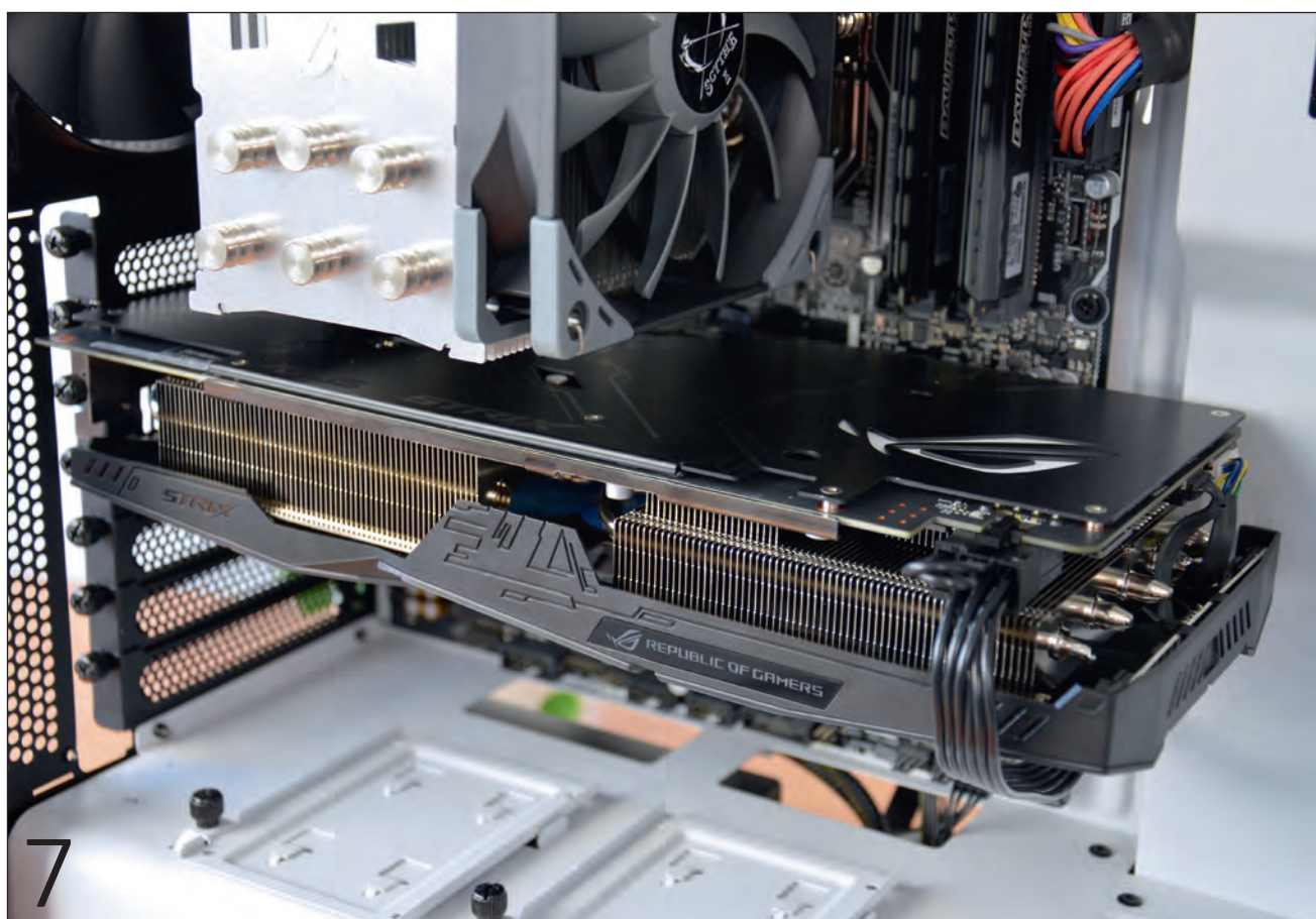
7 De videokaart plaats je in het bovenste PCI-e slot, vergeet hem ook niet van stroom te voorzien met de PCI-e kabel vanuit de voeding
